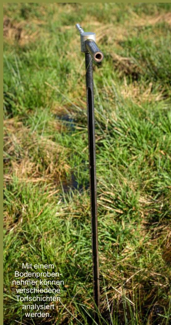
Mit einem Bodenprobennehmer können verschiedene Torfschichten analysiert werden.
